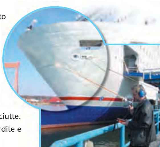
Prove di tenute accurate e veloci attraverso un sensore parabolico.
