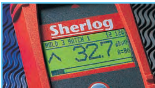
Prova di ermeticità di tenute e boccaporti con misure in DbμV.
