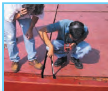
Il sensore flessibile permette un facile controllo in siti difficili da raggiungere
