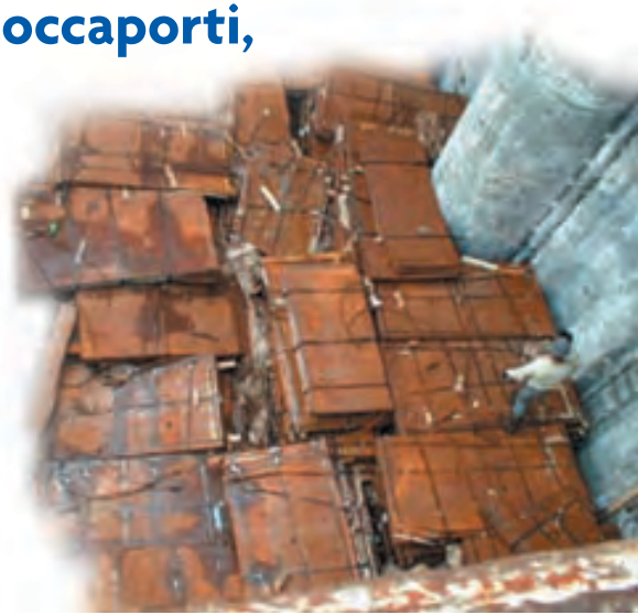
Lamine di ferro contaminate dall'acqua del mare.
