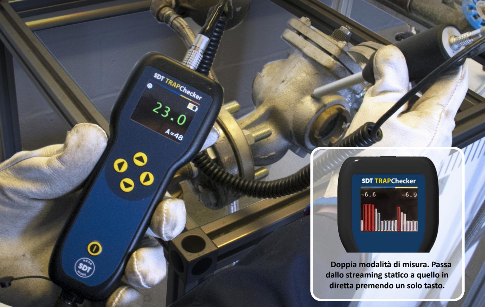
Doppia modalità di misura. Passa dallo streaming statico a quello in diretta premendo un solo tasto.
