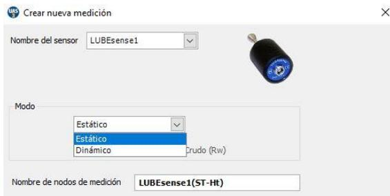
Para las mediciones por ultrasonidos, UAS3 le ofrece la opción de elegir entre Static (Estático) o Dynamic (Dinámico), y para las mediciones de temperatura, puede definir el intervalo de medición y la emisividad. Si su instrumento solo tiene capacidades estáticas (LUBExpert, SDT270 SU), debe elegir Estático. Si se selecciona dinámico, su instrumento no reconocerá la medición.
