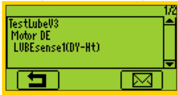
Si se elige la medición dinámica, su SDT270DU LUBExpert recopilará automáticamente los datos dinámicos de su lectura inicial y final. El proceso es el mismo que se describió anteriormente, con la diferencia de que estará proporcionando datos adicionales muy valiosos para el monitoreo de la condición del rodamiento.
