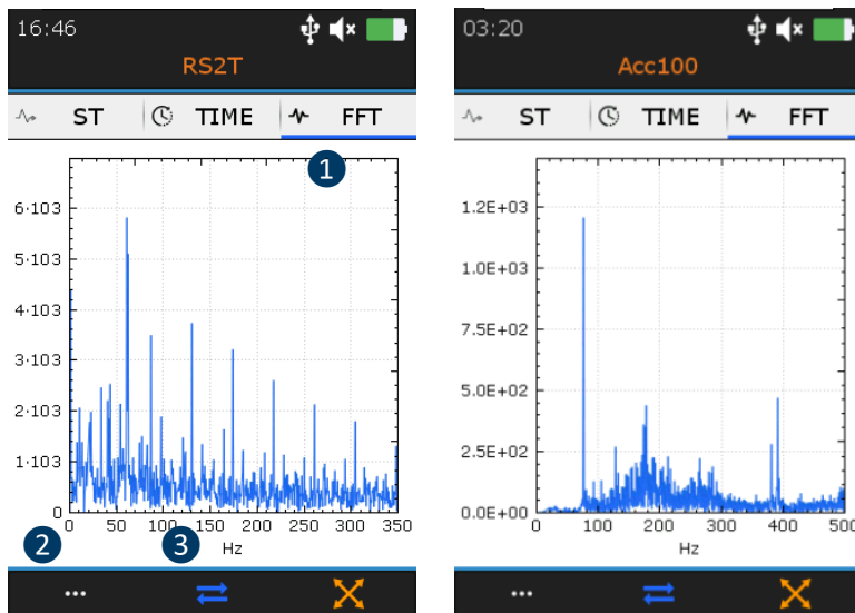
Figure 15-1 : Vue du spectre, spectre ultrasonore à droite et spectre vibratoire à gauche
