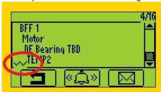
L'indication de la coche s'applique à tous les paramètres de mesure/capteurs.
