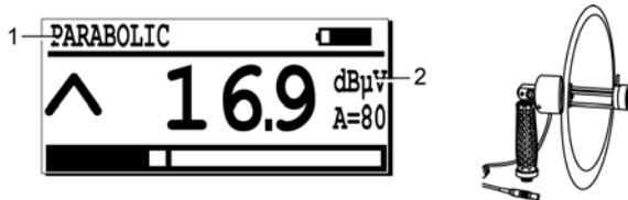
L'icône spécifique lors de l'utilisation d'un capteur parabolique.
