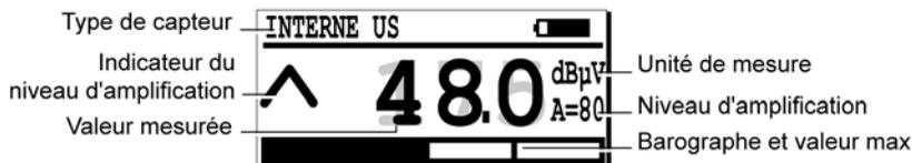
L'afficheur du SDT 170 S+ indique la mesure sous forme numérique.
