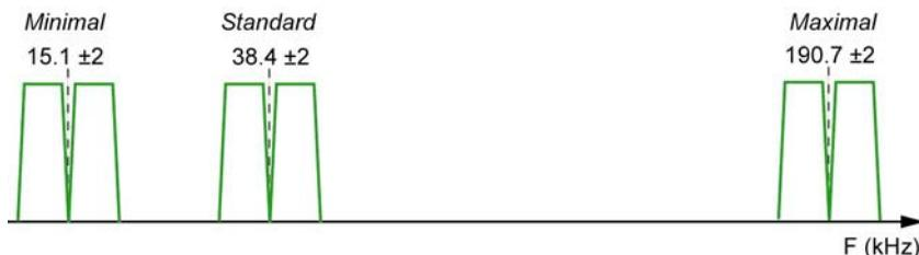
Les bandes de fréquence sont utilisées en fonction du type de bruit à détecter.
