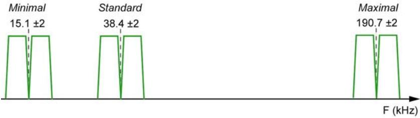
Les bandes de fréquence sont utilisées en fonction du type de bruit à détecter.
