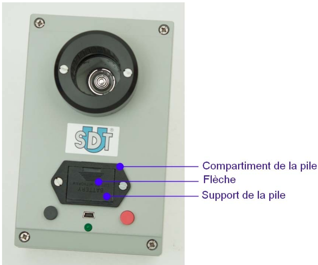
Figure 5 : emplacement du compartiment de la pile
