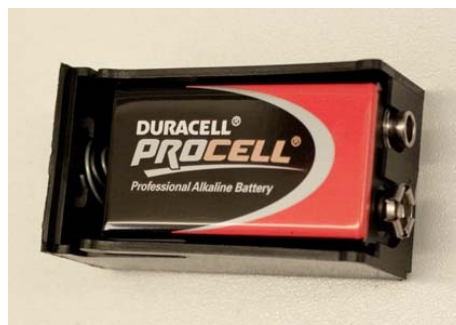
Figure 7 : la pile dans son support
