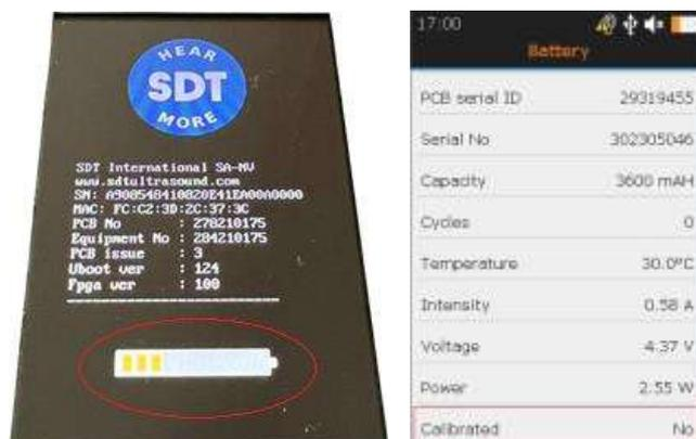
Se è stato identificato un errore di calibrazione della batteria, è necessario effettuare una carica completa della batteria. Per eseguire una carica completa della batteria, procedere come segue:
